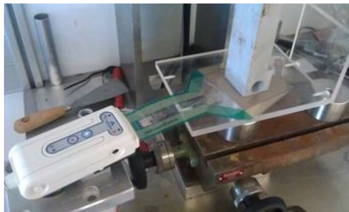
Figura 1: Calibrado del sensor de medición de presiones
